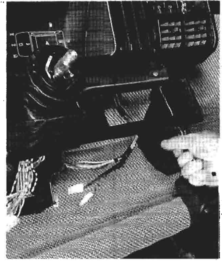
Smontaggio-montaggio cassetto autoradio
