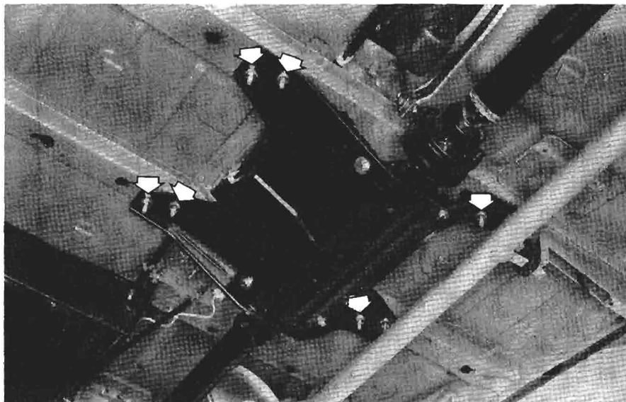
Stacco-riattacco complessivo albero di trasmissione dalla scocca
